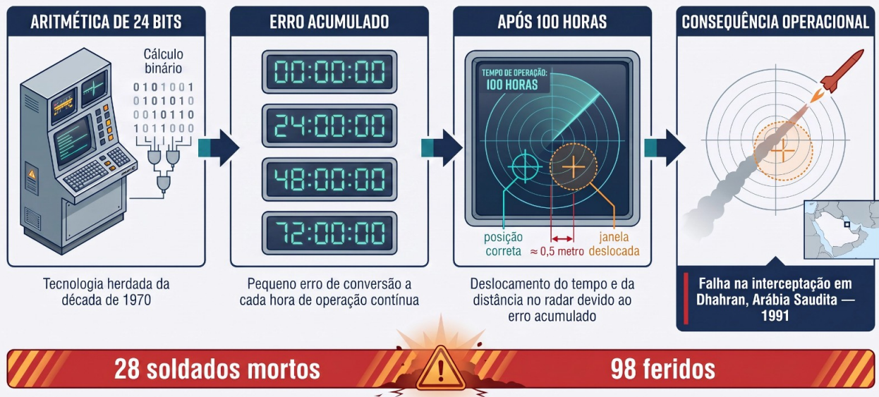
Figura 7: Infográfico esquemático sobre a falha de interceptação do sistema Patriot em Dhahran, durante a Guerra do Golfo (1991), atribuída ao erro de arredondamento acumulado na aritmética de 24 bits do computador de controle após 100 horas de operação contínua. Os valores e a reconstrução visual baseiam-se no GAO, Report NSIAD-92-26 (1992), e em Postol (1992).
