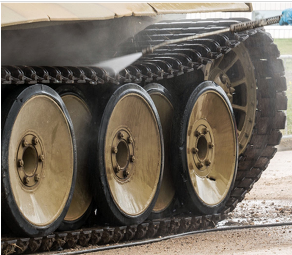
Figura 2: Suspensão original do Tiger I: As rodas de apoio originais instaladas no Tiger I tinham 800mm de diâmetro, feitas de aço com revestimento de borracha maciça nas bordas. Havia 24 por lado, com três montados em cada braço de suspensão (THE TANK MUSEUM, 2026).
