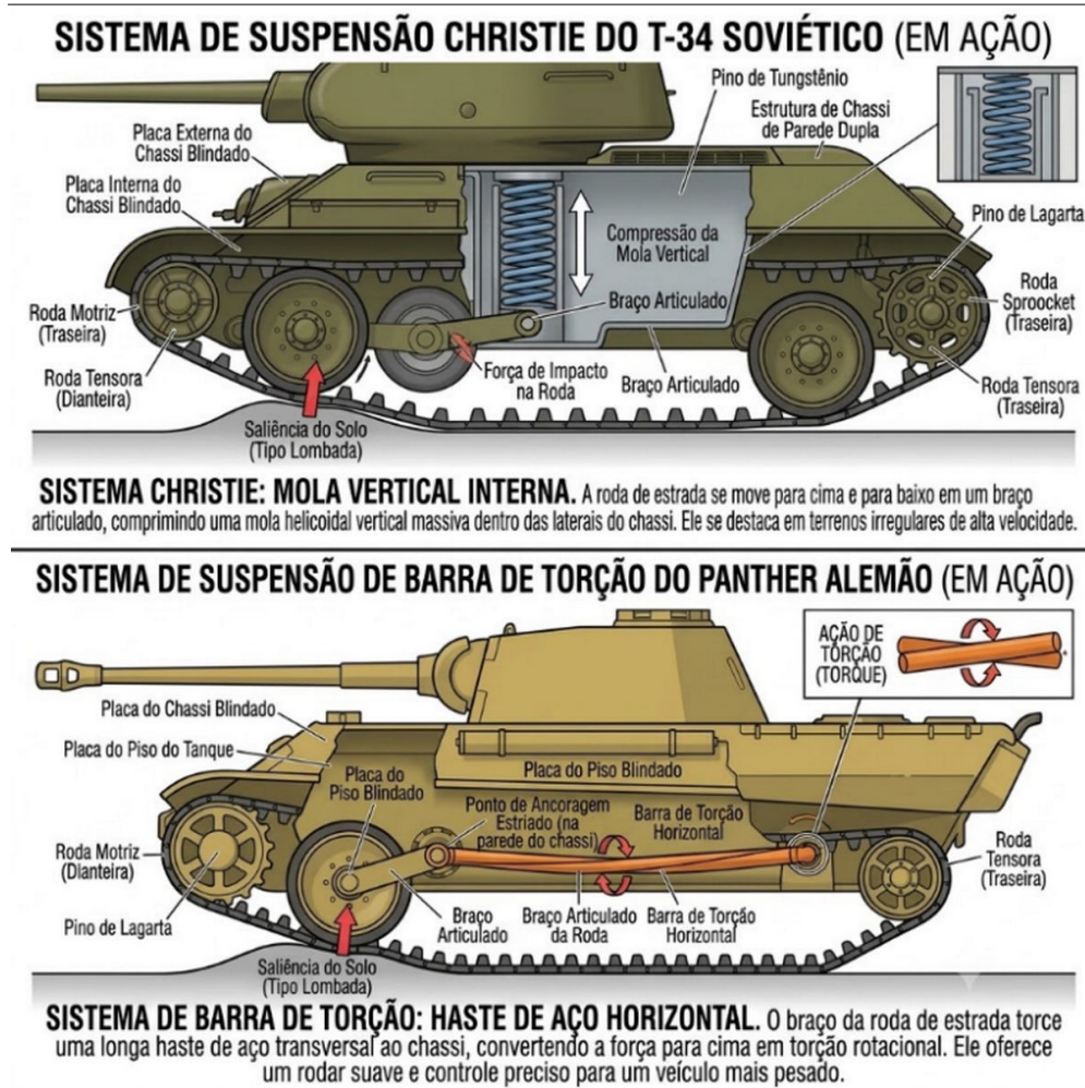
Figura 6: Comparação entre a suspensão Christie soviética e as barras de torção alemãs.
