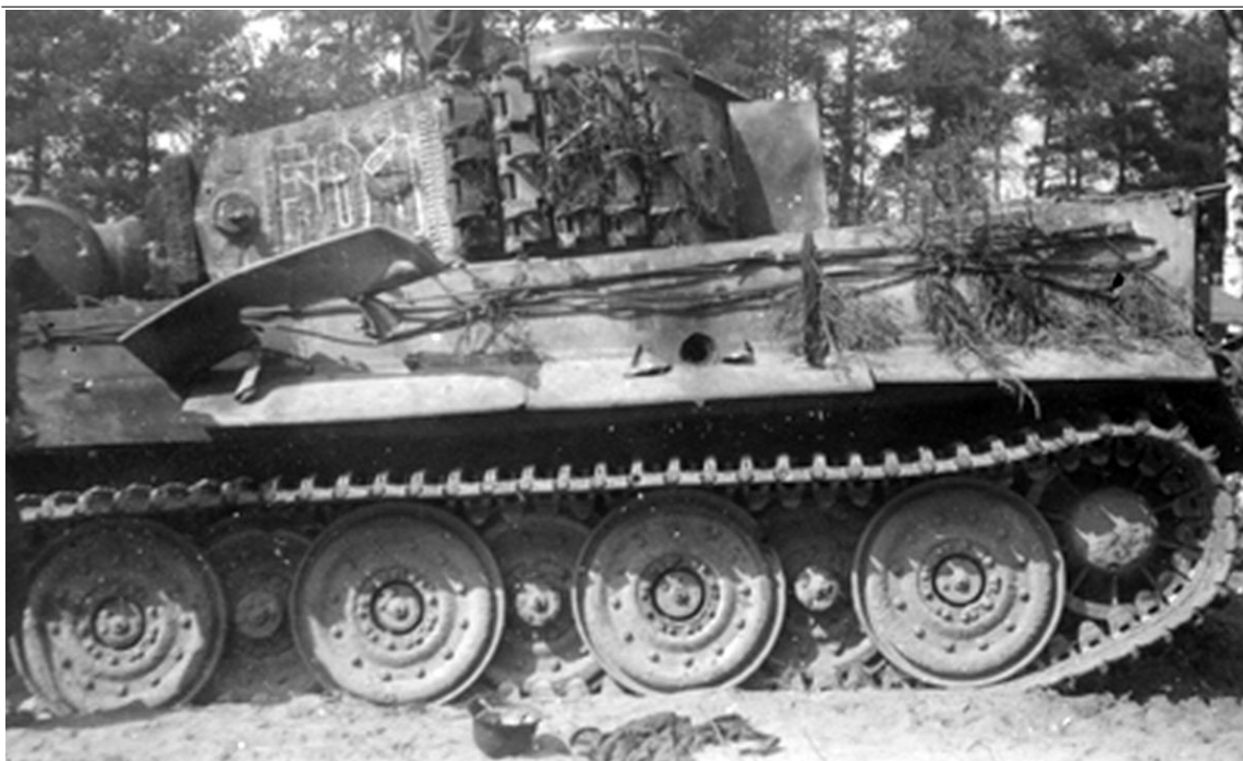
Figura 4: Blindado Tiger já adotando a alteração na suspensão Knipkamp, onde novas rodas de apoio sem a camada de borracha foram desenvolvidas em 1943 e introduzidas a partir de fevereiro de 1944.
