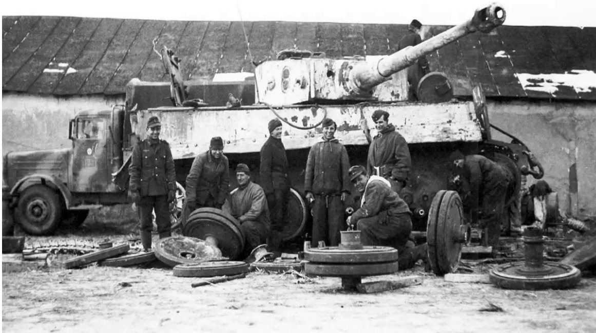
Figura 3: O desafio do “Xadrez Mecânico”: mecânicos alemães sorriam nesta foto, mas certamente praguejavam por dentro. O arranjo de rodas sobrepostas de Knipkamp transformava qualquer reparo em tormento: para trocar uma única roda de apoio era preciso remover várias outras, conforme a sua posição na suspensão. No teatro de operações do leste, na lama e no frio, isso era simplesmente um inferno.
