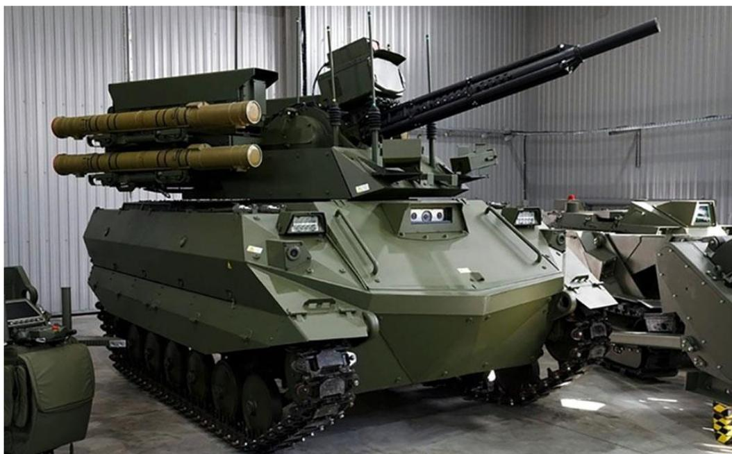
*FIGURA 2: VTNT Uran-9 com canhão de 30mm e mísseis anticarro ATAKA (Wikipedia/mil.ru/CC BY40).*
