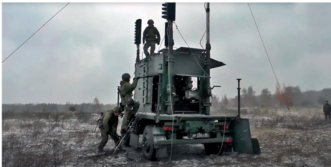
FIGURA 1: O sistema de interferência Zhitel pode desligar, por dezenas de quilômetros, comunicações de GPS e satélite. Esta imagem mostra a base de uma das quatro antenas em uma configuração típica (informnapalm.org).
