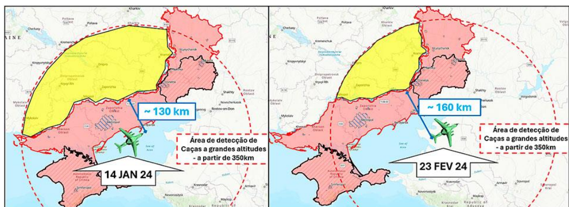
Figura 6: Comparando a posição das duas aeronaves A-50 nota-se a redução da área de cobertura para a detecção de aeronaves de caça a grandes altitudes, com o afastamento da posição do A-50 da linha de contato, demonstrando o cuidado da Força Aeroespacial Russa com a defesa antiaérea ucraniana.
