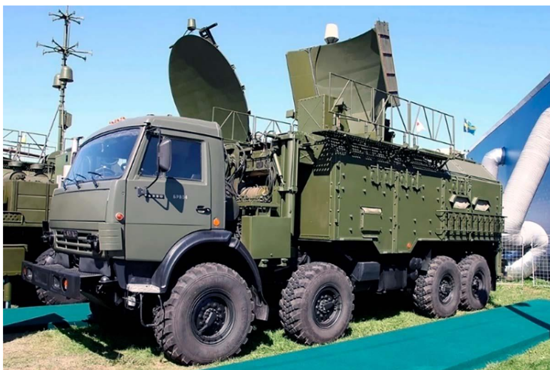
Figura 18: O Moskva-1 é um sistema passivo que coleta os dados de emissões inimigas que serão usados pelo Sistema Krasukha, para interferir nos equipamentos inimigos.
