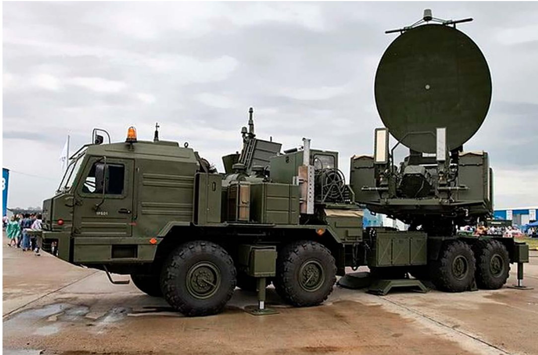
Figura 16: O sistema Krasukha-2 é montado em caminhão BAZ-6910 operando na Banda S.
