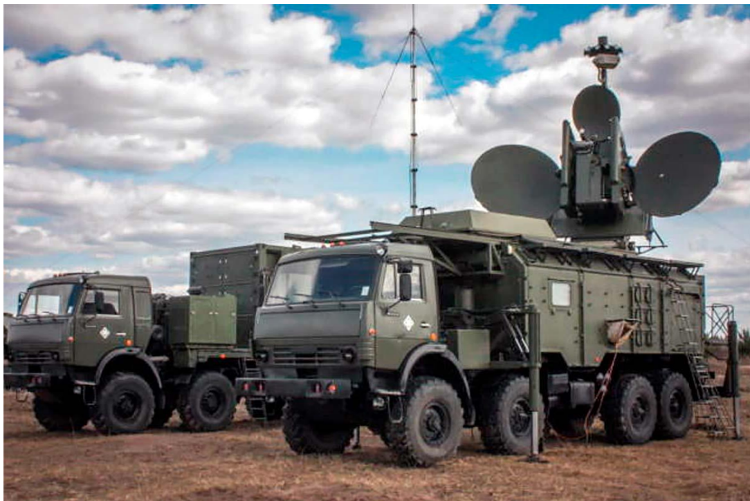
Figura 17: Sistema Krasukha-4 consiste em dois caminhões Kamaz-6350, sendo um o posto de comando e outro equipado com sensores, operando nas Bandas X e Ku.
