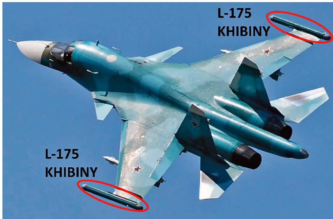
Figura 19: O Sistema L-175 Khibiny é um equipamento de GE que faz a proteção da aeronave Su-34, despistando radares de direção de tiro e de guiamento de armamentos.
