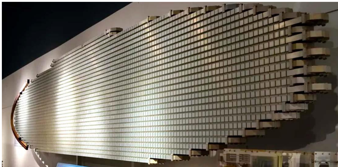
Figura 9: Radar APY-2 de varredura eletrônica fornece a capacidade para que o AWACS cumpra a sua missão.
