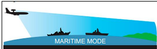
Figura 14 (esq.): Modo Marítimo, que emite um pulso radar estreito que separa o movimento do mar e os navios inimigos de qualquer tamanho; Figura 15 (dir.): Modo Passivo, quando o radar deixa de transmitir em determinado setor, mas mantém a recepção de sinais emitidos pelo inimigo. Muito efetivo em área com presença de interferência inimiga. Neste caso, aparecerá no radar uma linha mostrando a direção da interferência.
