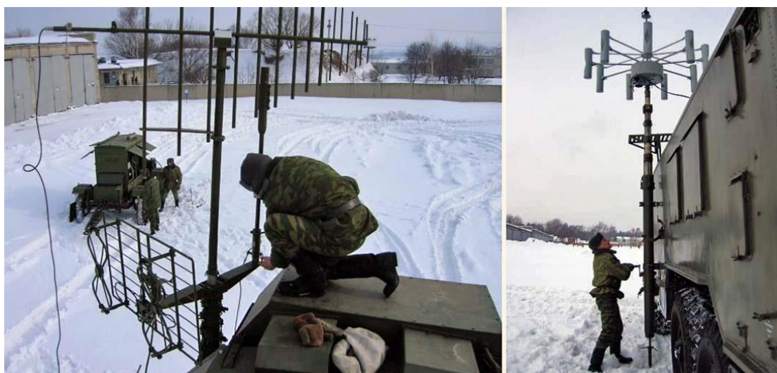
FIGURAS 11 e 12: Montagem do sistema de GE russo R-934B.
