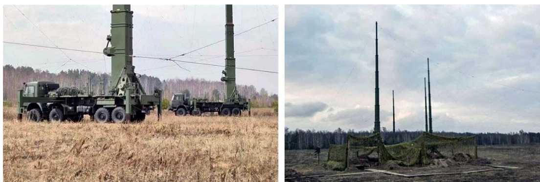
FIGURAS 16 e 17: Caminhões Kamaz, base de uma das antenas de 32 m de altura do Sistema de GE russo Murmansk e conjunto de quatro antenas montado.
