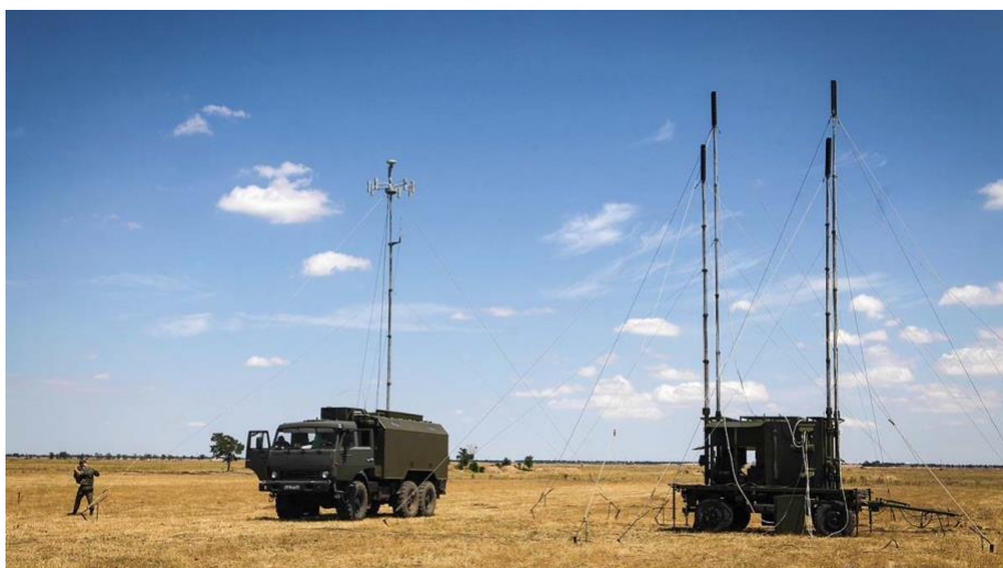
FIGURA 7: Sistema de GE russo R-330Zh Zhitel.
