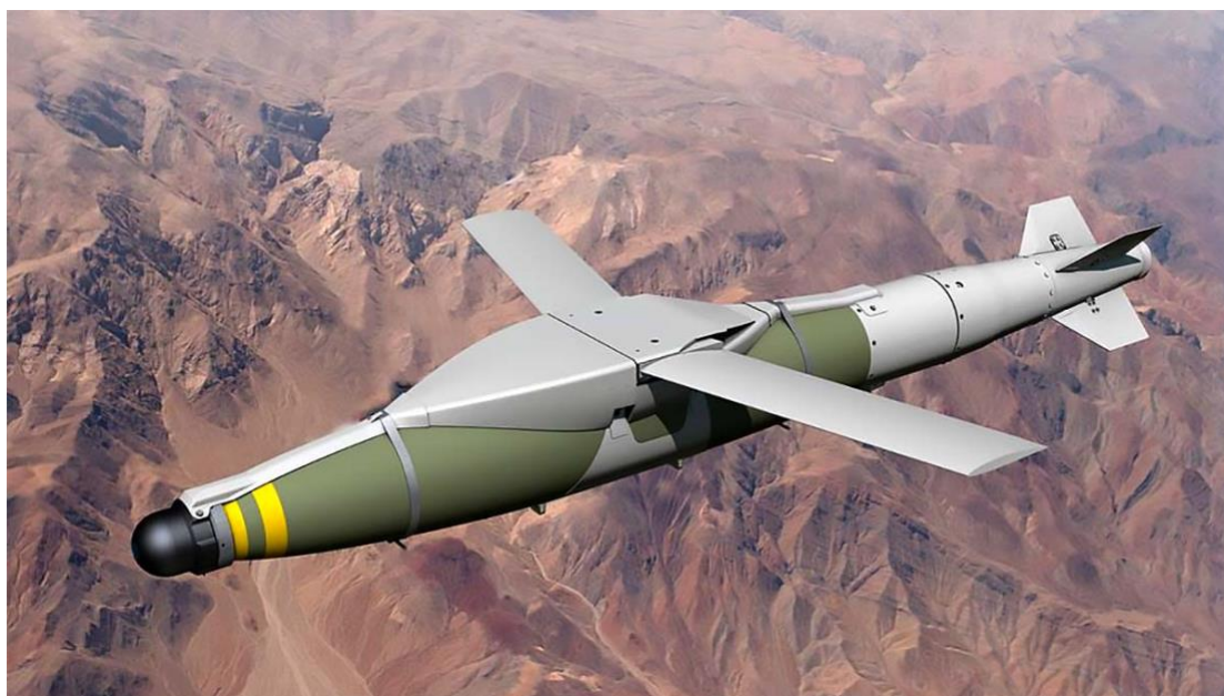
FIGURA 3: Bomba com kit JDAM-ER produzido pela Empresa Boeing. Destaca-se o conjunto de asas para aumento de alcance do armamento.
