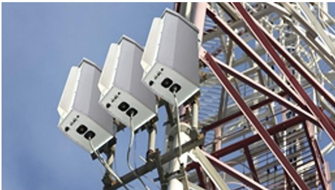
FIGURA 9: O sistema de GE russo Pole-21 é um dos responsáveis pela interferência nos sistemas orientados por navegação GPS.
