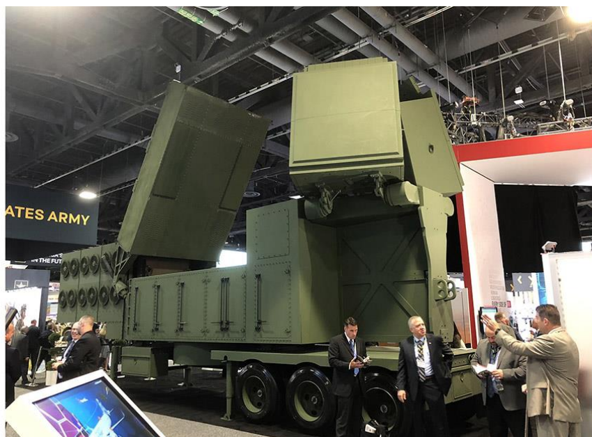
FIGURA 2: Radar AN/MPQ-65A com antenas adicionais do programa LTAMDS (Simon Petersen via Jon Hawkes/Twitter).
