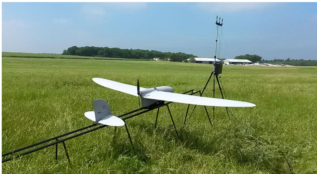
Drone SMDR em sua plataforma de lançamento com o mastro de rádio.
