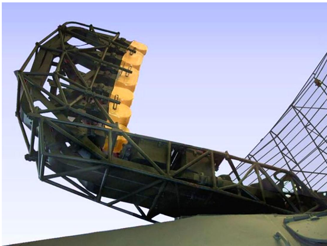
Close nos guias de onda e nas cornetas de emissão de um radar “clássico” usando vários transmissores.
