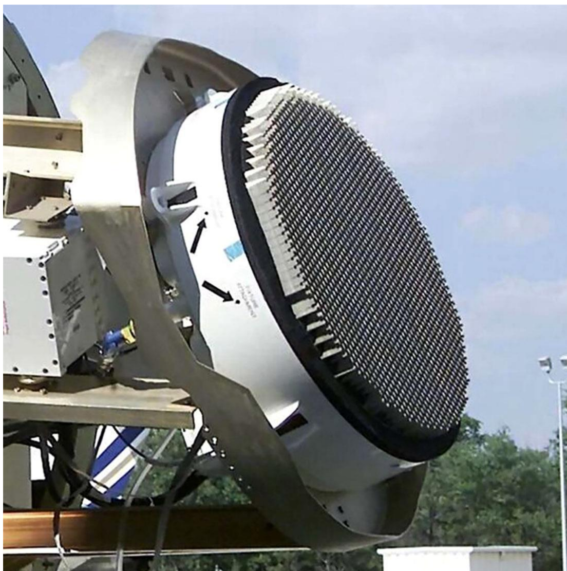
Antena do radar AN/APG-81 instalada no F-35 orientada "inclinada" para cima.
