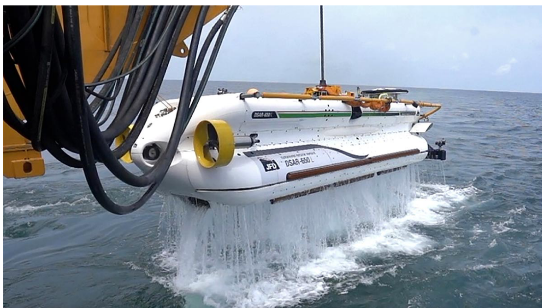
O DSRV (Deep Submergence Rescue Vessel) operado pelo SCI Sabarmati, da Marinha da Índia (Foto: Eletimes).
