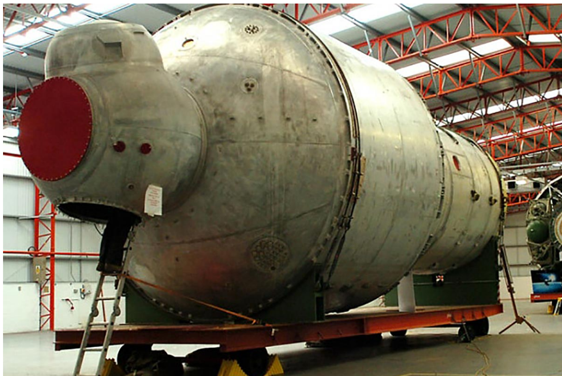
Um casco da Almaz OPS ainda “no ferro”, como dizem os russos. Os compartimentos eram produzidos em liga de alumínio-magnésio AMg-6. Veja um técnico na escada à esquerda embaixo, inspecionando a câmara PrK. O compartimento de ejeção da cápsula KSI está ausente (ele esconderia todo o corpo do homem, se estivesse instalado).
