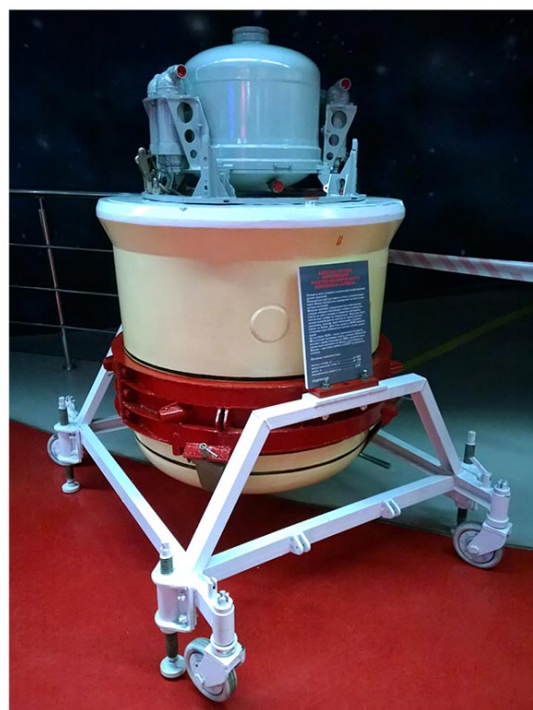
Cápsula de retorno de informações KSI: 1 – ejeção da cápsula, 2 – ignição dos motores de rotação, 3 – ignição dos retrofoguetes, 4 – ignição dos motores de contrarotação, 5 – descarte da unidade de propulsão, 6 – descida balística na atmosfera, 7 – abertura do paraquedas de freio e descarte do escudo de calor, 8 – abertura do paraquedas principal, inflação do airbag e ativação do radiofarol, 9 – aterrissagem.
