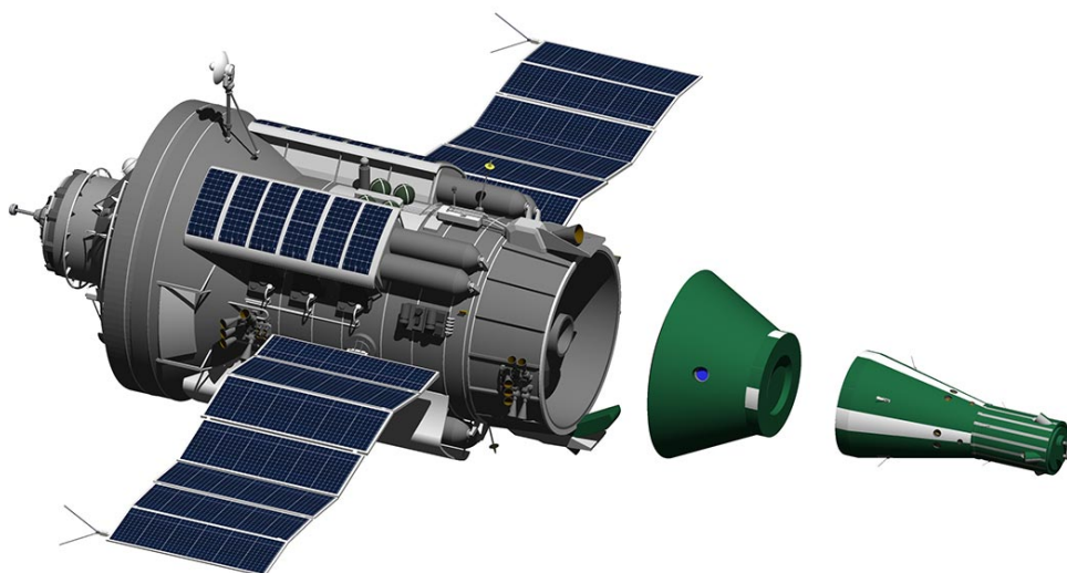
O TKS dividido em seus componentes: O FGB com painéis solares, a Cápsula Vosvracheniye Apparat, a ser usada para o lançamento e retorno dos cosmonautas e o seu “nariz”, com os retrofoguetes para reentrada e paraquedas/motores de pouso.
