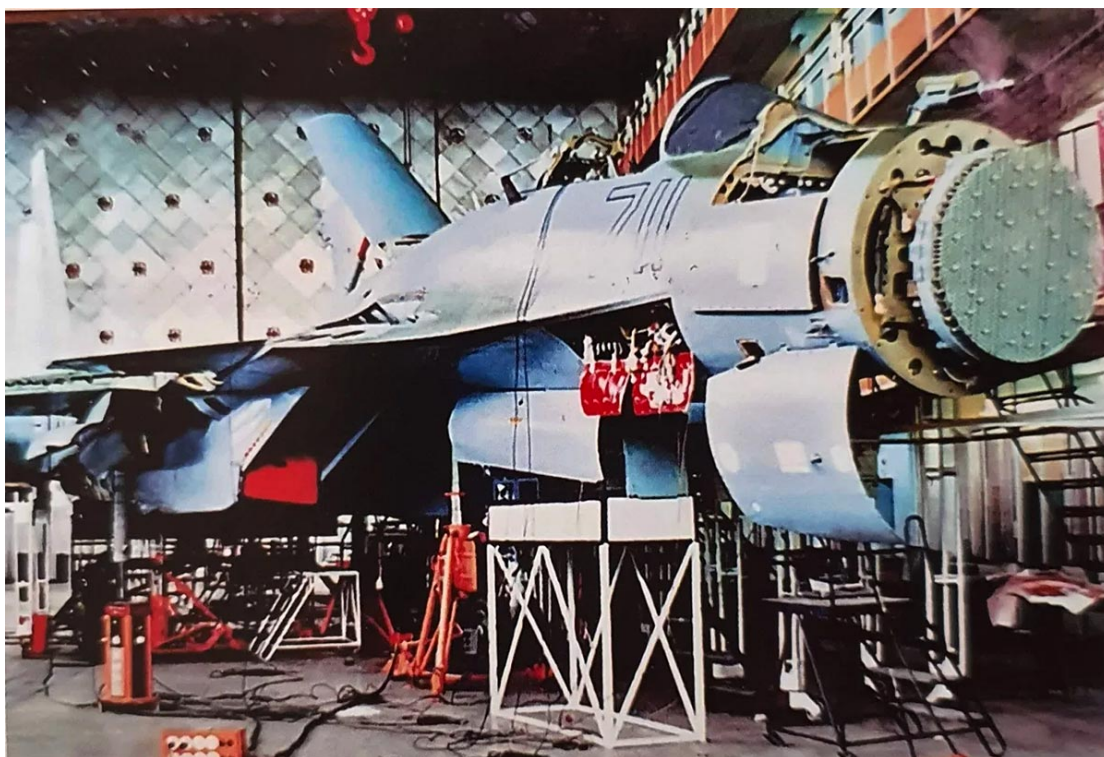
IMAGEM 08: Protótipo T10M-11 com o radar N011M.
