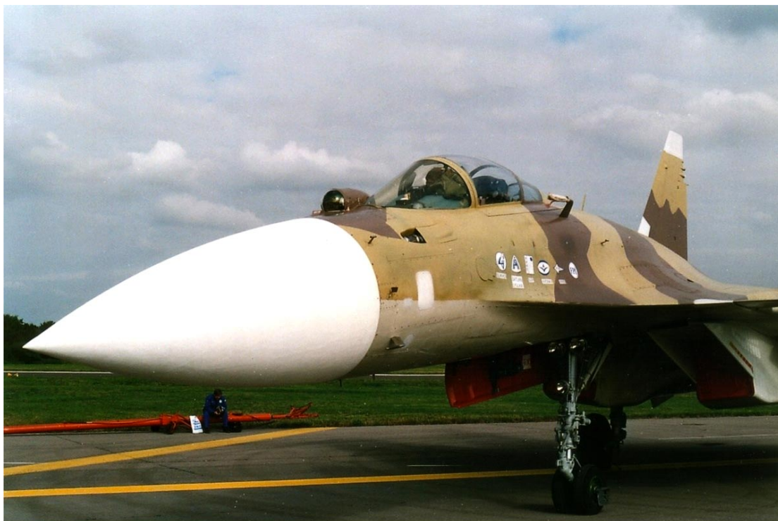
IMAGEM 07: O Su-37 tinha um grande radome para acomodar o radar.
