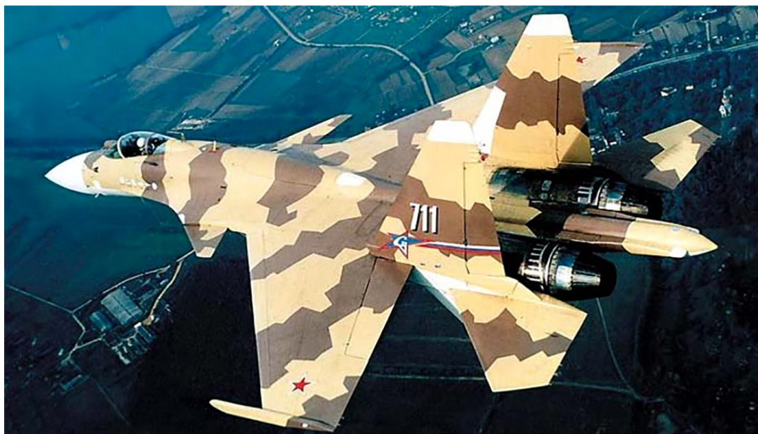
IMAGEM 04: O Su-37 tinha uma configuração aerodinâmica triplano.
